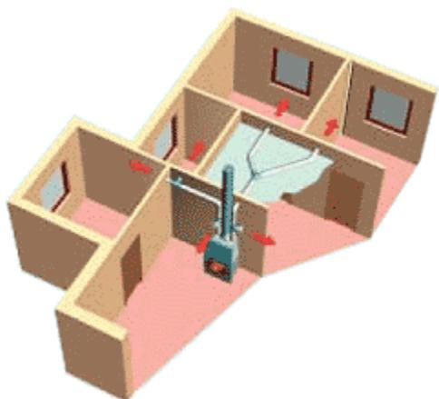
L'elevata potenza termica dei monoblocchi consente di realizzare un vero e proprio impianto di riscaldamento mediante un adeguato sistema di canalizzazione forzata (max 4-5 metri).
