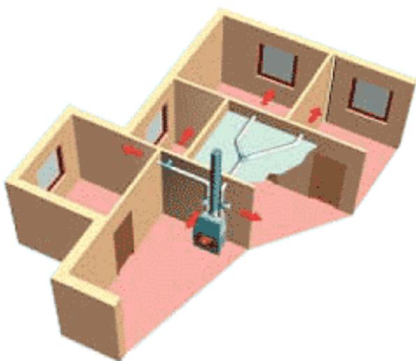
L'elevata potenza termica dei monoblocchi consente di realizzare un vero e proprio impianto di riscaldamento mediante un adeguato sistema di canalizzazione forzata (max 4-5 metri).
